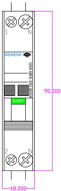
Brandschutzschalter-LS-Kombi 5SV6 COM mit Messfunktion als Energiezähler B - Charakteristik
