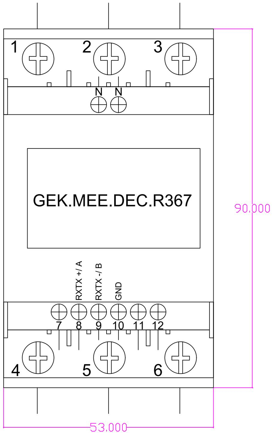
Dreiphasen Energiezähler 65A Modbus, RS485, MID T:63mm
