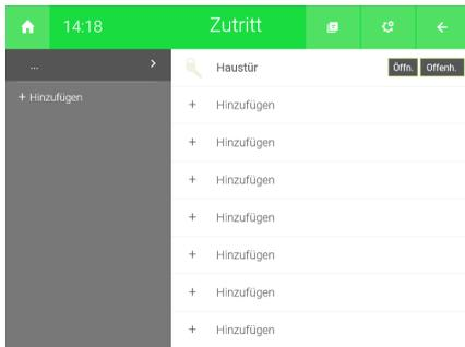
Melden Sie sich im myGEKKO OS als Konfigurator an und wechseln Sie in das System Zutritt. Hier tippen Sie auf die Zahnräder und dann "IO-Konfiguration", um in die Leserkonfiguration zu gelangen.
