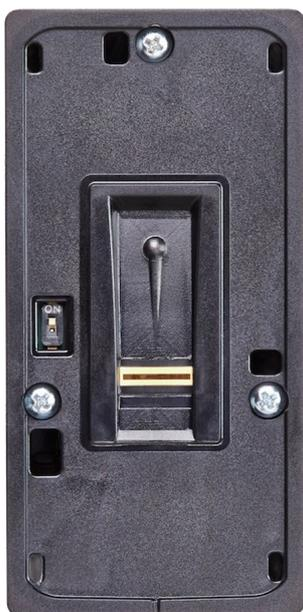
FPD Fingerscanner ist ein biometrisches Sensorterminal zur Erfassung von Finger- GEK.COS.FPD.RS41 prints mittels eines RF-Zeilensensors von Authentec.
