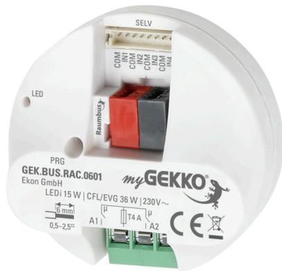
Aktor mit 4 digitalen Eingängen und 2 digitalen Ausgängen mit jeweils 4A Schaltleistung zum Schalten von Verbrauchern bis 900W. KNX vorkonfiguriert. Unterputzmontage in Standard-Gerätedose (Ø 68mm). Unterputzmontage in Standard-Gerätedose (Ø 68mm).
