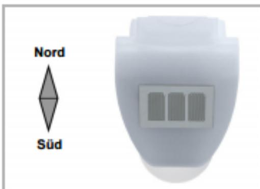
*Bei Installation auf der Nordhalbkugel muss die Wetterstation nach Süden ausgerichtet werden.*
